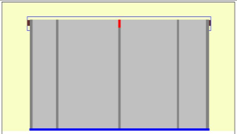
Пример 3 – отсекающая шина провисает по краям
