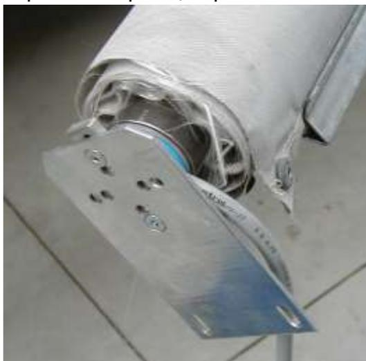
Вал с установочными устройствами вложить в корпус, с учетом расположения мотора (левое/правое) и направлением разворачивания полотна, указанные в конструкторской документации.
